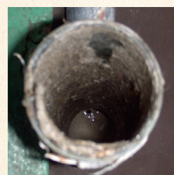
1mm程のカルシウムが付着硬化しており簡単に剥れない
